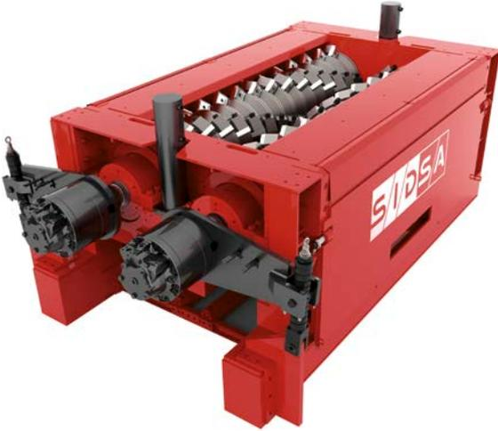
Nos broyeurs fins sont constitués d'un ou deux arbres chacun entraînés par un moteur à faible vitesse et à couple élevé.
