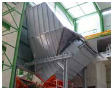
Dociskacz naporowy Zapewniający popychanie odpadów w kierunku części tnących
