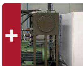
**Coffret local fixé sur le groupe hydraulique** permet le pré-câblage en atelier pour réduire la charge de travail de mise en service
